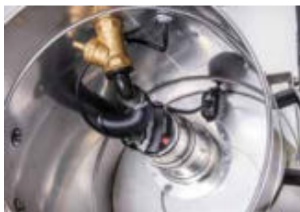
Mit fest eingebauter Edelstahl-Tauchpumpe.
